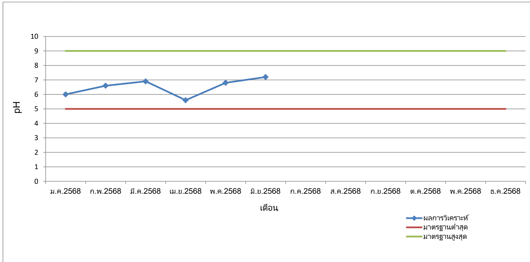
ภาพที่4-1 แสดงปริมาณค่าความเป็นกรด-ด่าง (pH) ในน้ำทิ้งหลังบำบัด
